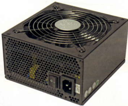
Chieftec APS-550C: Dokumentation der 12-V-Schienen an den Stecksystembuchsen außer ATX12V/EPS12V, gute Standby-Effizienz
