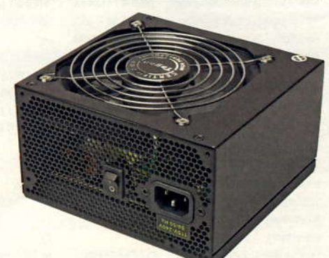
Tagan TG600-U33II: geringe Verluste im Standby-Betrieb, noch erträglich laut bei hoher Last, mäßig störimmun
