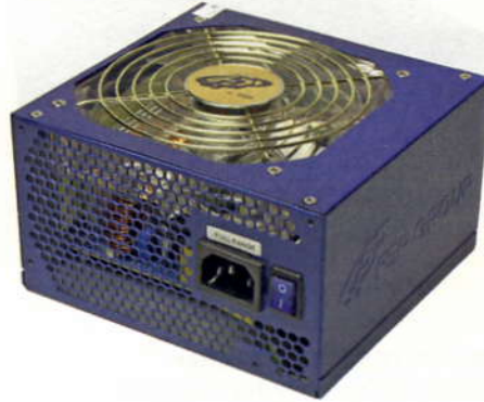
FSP Epsilon 80plus 600: kein Sonderangebot, hoher Wirkungsgrad bei Halb- und Volllast, noch gute Geräuscharm
